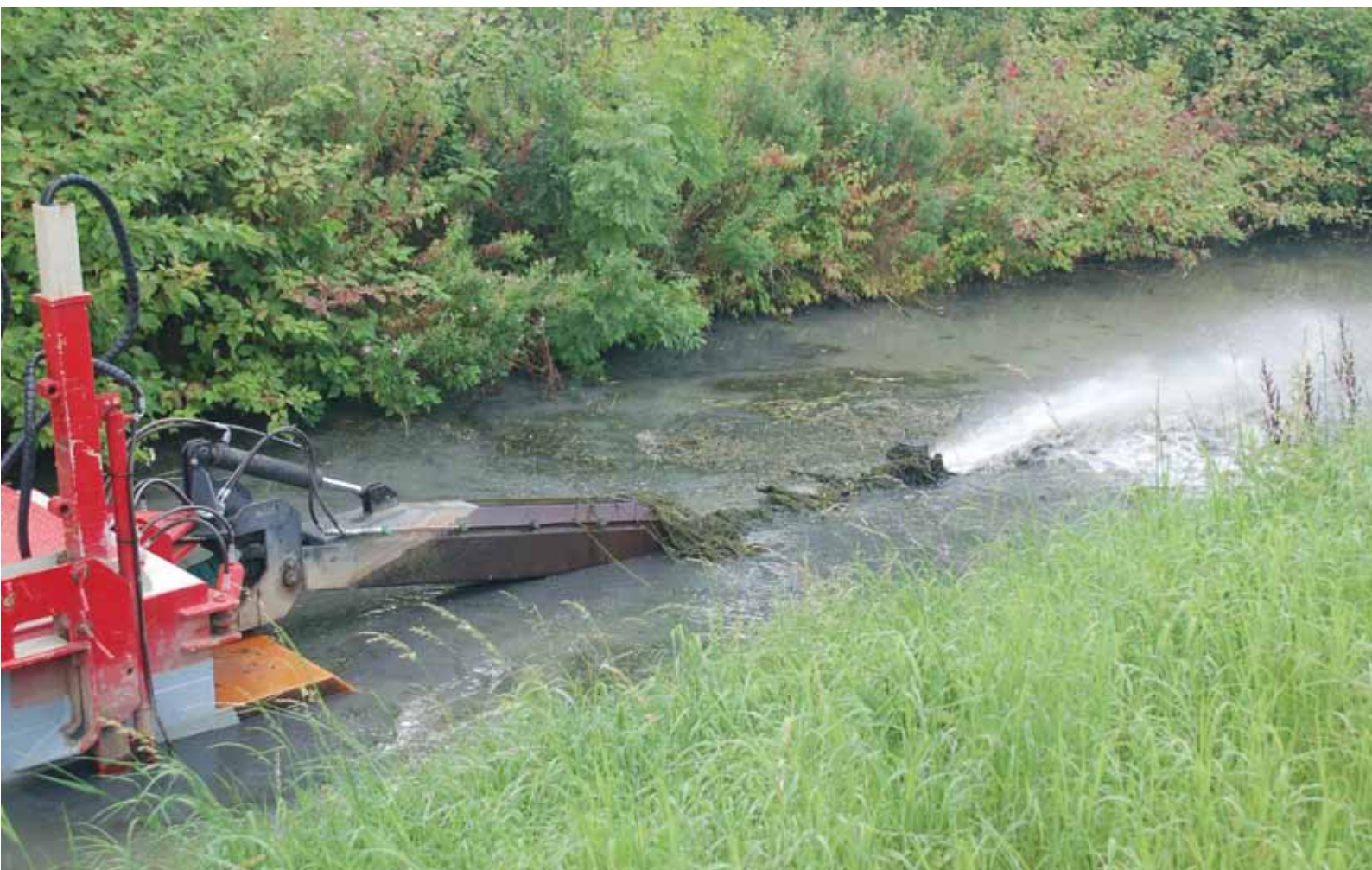
Af en toe komt de spuitkop boven het wateroppervlak uit om zich te ontdoen van planten.
