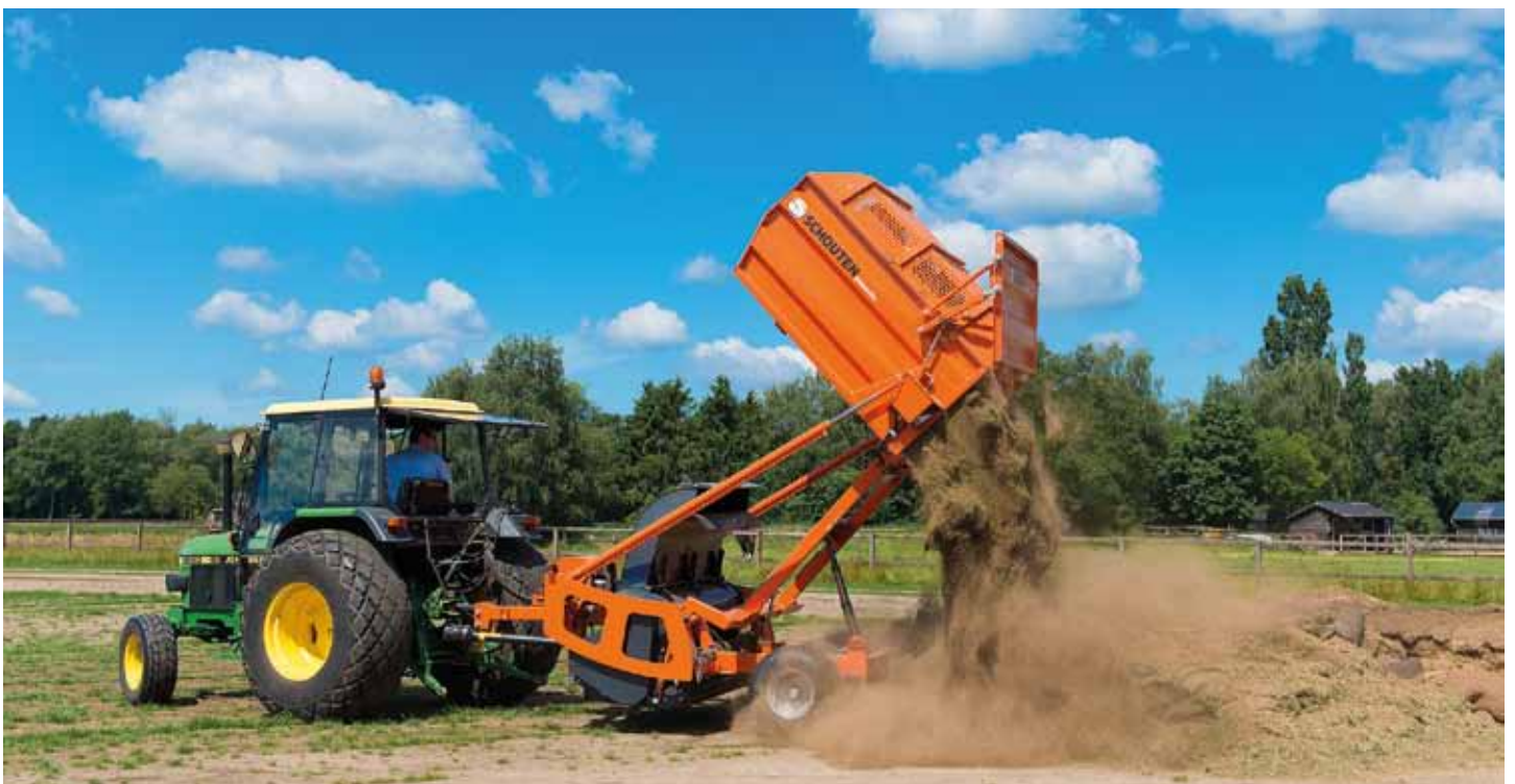
Door het hoogkipsysteem van de Phoenix PKH1803 ligt het lastgewicht altijd voor een deel vóór de wielas, waardoor de combinatie stevig staat.
