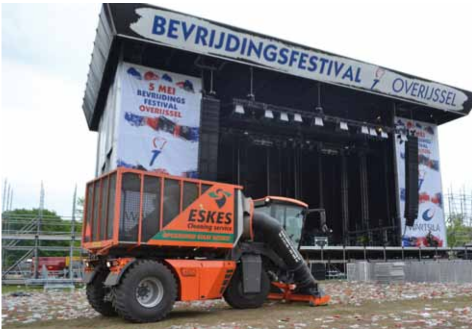
De exhausters zorgen voor een lichtsnelheid van 200 km/h in de pijpen
