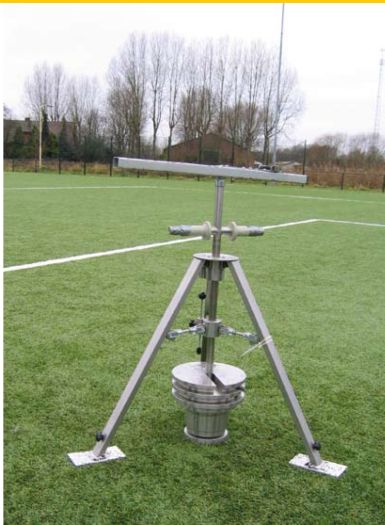
Figuur 2: Rotatoire grip meter; onder het valgewicht van 45 kg zijn 6 noppen in een ronde gemonteerd. Het draaimoment welke nodig is op het gewicht met 6 noppen rond te laten draaien staat voor de rotatoire grip.
